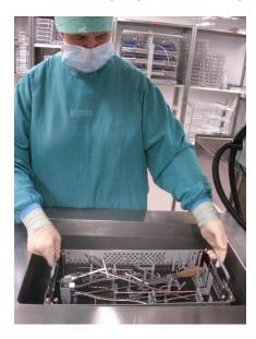
Die eigentliche Reinigung und Desinfektion erfolgt maschinell in einem rund 1 Stunde dauernden vollautomatischen Programm. Dafür stehen uns folgende Geräte zur Verfügung.
